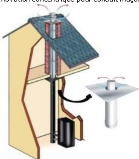
Figure 2.5 – Départ Plafond (tubage rigide avec kit de rénovation concentrique pour conduit maçonné)
