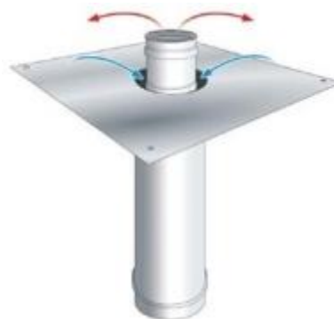
Figure 5.4 – kit de rénovation concentrique pour conduit maçonné avec tubage rigide
