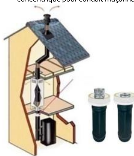
Figure 2.6 – Départ Plafond (tubage flexible d'un conduit métallique existant avec kit de rénovation concentrique)
